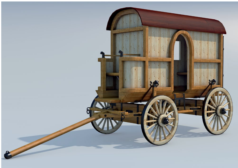
Fig. 10 - Ricostruzione virtuale 3D di una carruca dormitoria, comodo carro adibito al trasporto notturno di più persone, con copertura in legno o cuoio.
