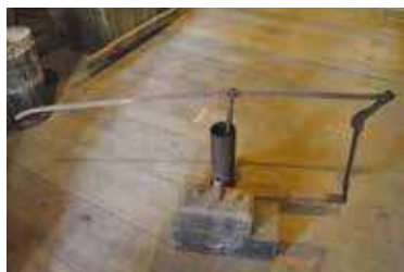
Foto 32 e 33. Pompa manuale e maniglia per l'inserimento dei fascioni metallici nelle botti. Fonte: Museo di Luiz Henrique Fitarelli.
