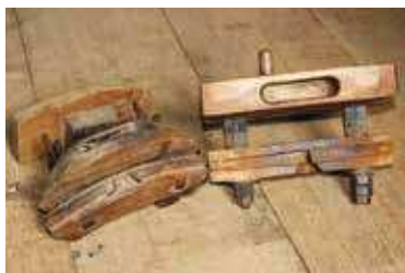
Foto 32 e 33. Pompa manuale e maniglia per l'inserimento dei fascioni metallici nelle botti. Fonte: Museo di Luiz Henrique Fitarelli.
