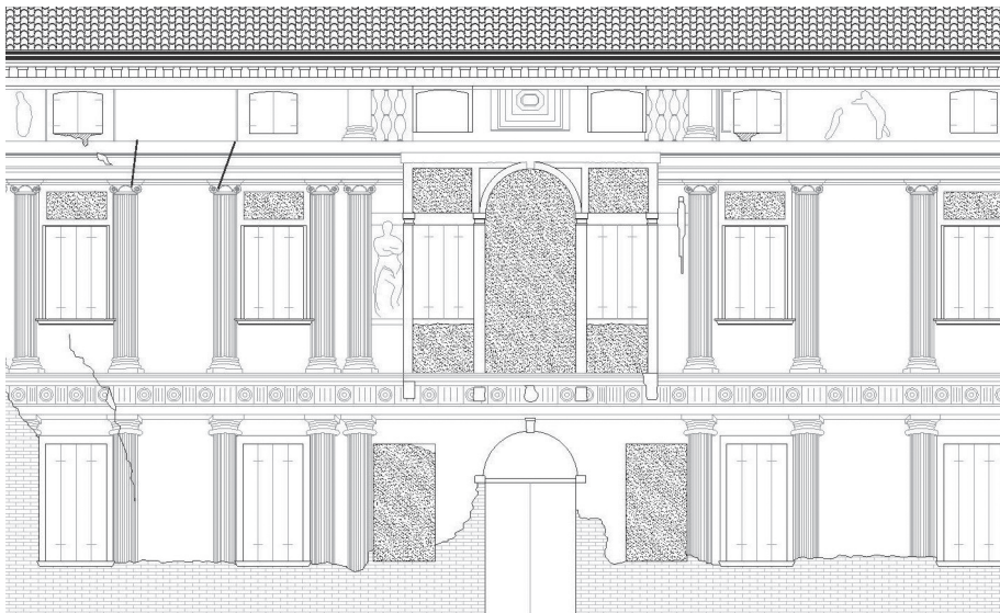
7. Ricostruzione grafica della facciata di Villa Giustiniani: intelaiatura architettonica dipinta ad affresco con dissimmetria tra finto colonnato a destra e a sinistra dell'ingresso sud (disegno di Luciano Mingotto).
