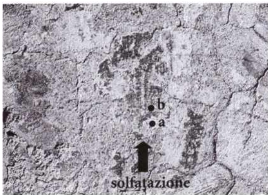
Fig. 39. Fenomeni di esfoliazione della pellicola pittorica [cfr. Appendice a colori , Fig. 17 p. 203].
