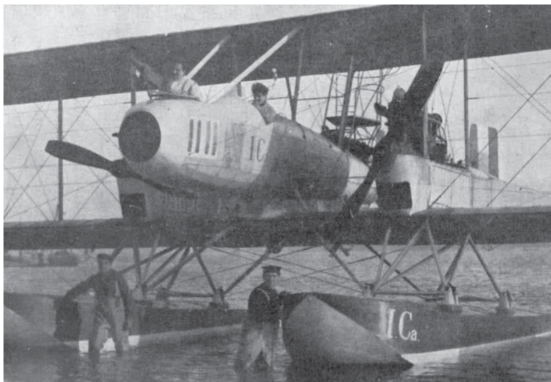
Idrosilurante «Caproni 47» con motori da 600 cavalli.
